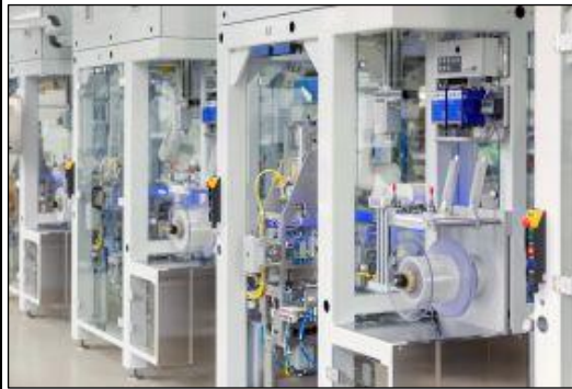
Bild 2: Eine komplett automatisierte Montage-Linie, bestehend aus bewährten Knoll-Feinmechanik-Modulen, die mit jeweils eigener Steuerung unterschiedliche Prozessschritte abbilden.
