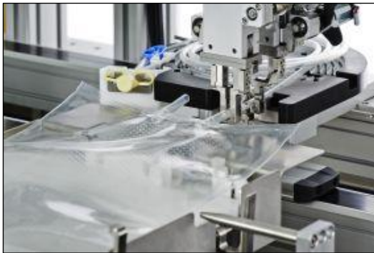
Bild 1: Ein Blick in den Kernprozess der Schlauchmontage: Gut sichtbar ist das Greifersystem mit dem Handling-Head, einer Eigenentwicklung von Knoll Feinmechanik.
